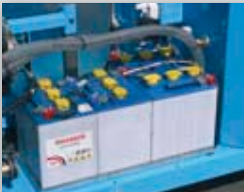
Gruppo batterie 24V. Unit batteries 24V.
